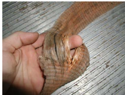
Figure 36: Sangle très endommagée? Mettez-la au rebut!
