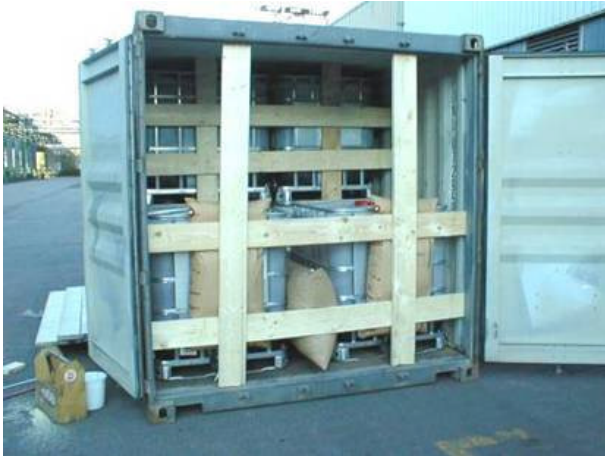
Figure 90: grands récipients pour vrac (GRV) empilés sur deux étages dans un conteneur
