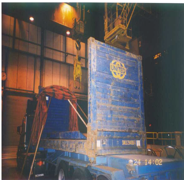
Conteneur «flatrack» avec bâche et fosse
