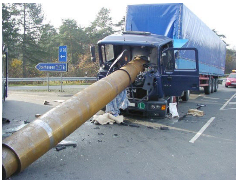
Figure 1: Lors d'un freinage brusque, les tubes d'acier mal fixés ont traversé le hayon et la cabine du conducteur.
